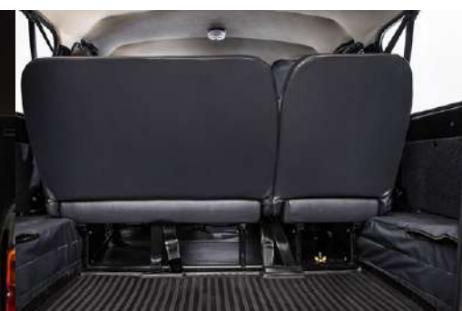
Para transportación de cargas y equipaje de grandes dimensiones, los asientos traseros se pueden plegar en la posición 60/40 o convertirlos en un espacio para dormir, plegándolos a 180°
